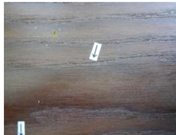
グラノール：導管に沿って割れが発生するも大きくない。
