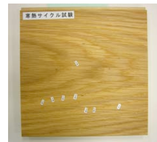
オイルS：導管に沿って数多く割れが発生する。
