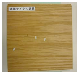
グラノール：導管に沿って僅かに割れが発生。
